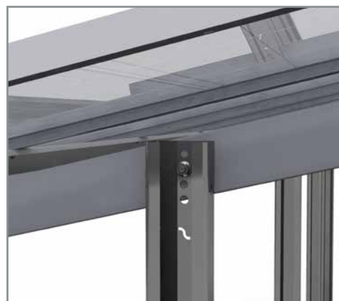
Anschluss Pfosten an Binder
