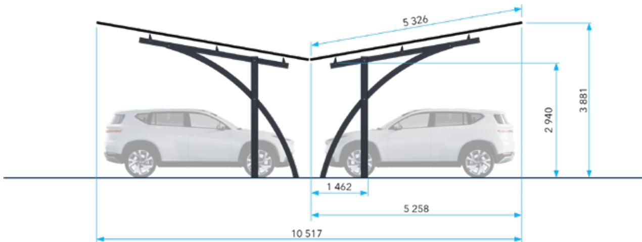
Abmessungen\* VOLTWING ECO-5H und ECO-5F in mm
