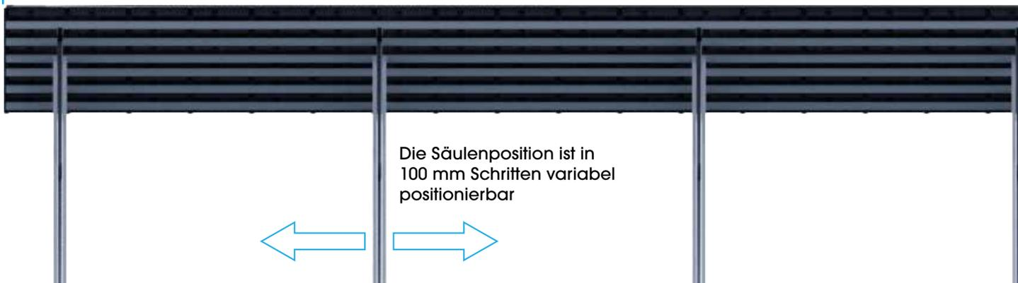
\*) Alle Abmessungen weisen fertigungsbedingt Toleranzen von bis zu 150 mm auf. Alle Abmessungen des Dachs sind auf Basis von Modulen mit einer Abmessung von B x L x H 1134 x 1722 x 35 mm abgeleitet.
